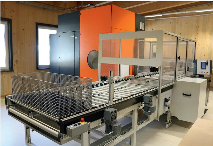
1 Die Mafac Java100 wurde für die Hohe Tanne mit Sonderlackierung ausgeführt sowie mit einem Transfersystem für die halbautomatische Beschickung ausgestattet © Mafac
