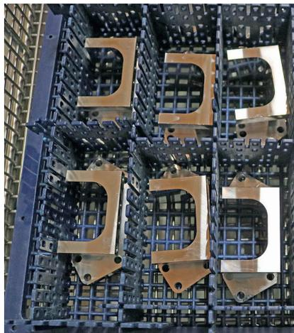
3 Nach der Reinigung und Trocknung sind Bearbeitungsrückstände wie Öl oder Schleifstaub sorgfältig entfernt und die Oberflächen absolut trocken © Mafac
